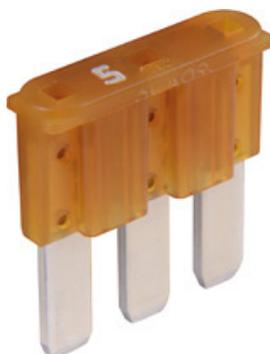
Die MICRO3-Sicherung besitzt drei Kontakte, wobei zwei Sicherungselemente sich einen gemeinsamen Mittelkontakt teilen. Durch die geringe Größe können mehrere Stromkreise auf engstem Raum abgesichert werden.
