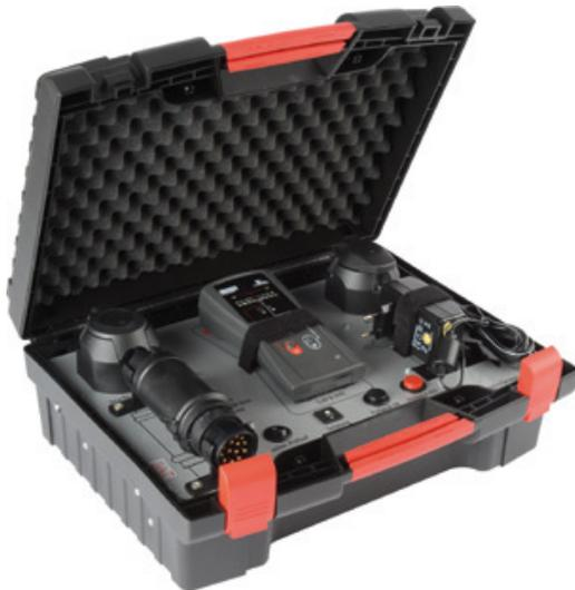
Mit dem Blinker kann sowohl die Belegung der Anhängersteckdose als auch die Beleuchtungsfunktion des Anhängers von nur einer einzelnen Person geprüft werden. Das Prüfgerät ersetzt und simuliert wahlweise das Zugfahrzeug oder den Anhänger. Der Anwender kann sich dabei die Beleuchtungssignale des Fahrzeugs auf der Fernbedienung anzeigen lassen oder mit der Fernbedienung alle Leuch-
