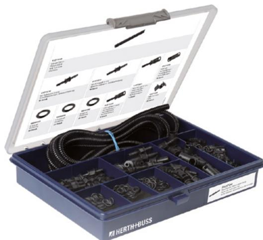
Mit dem Reparatursatz können einfach und schnell defekte Stellen in Waschwasserleitungen ausgetauscht werden. Zur Reparatur von Wellrohrleitungen mit der Nennweite 4,5 sind Wellrohrverbindungsstücke, Montageclips und Dichtungen in drei verschiedenen Durchmessern sowie ein 2,5 m langes Wellrohr enthalten.
