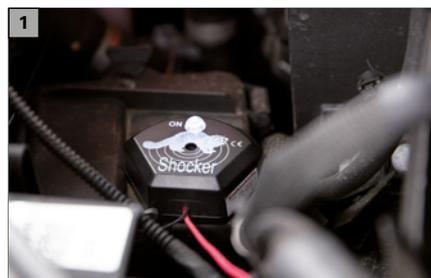
Um einen besseren Schutz gegen Marderverbiss erzielen zu können, sollte über jedes Einschluflloch im Motorraum ein Marder-Schocker installiert werden. Hierbei sollte der Einbauort so tief wie möglich gewählt werden. Das Gerät arbeitet im 12-Sekundentakt (siehe LED). Das Gerät ist so einzubauen, dass es mit der Marderabbildung in die Einschluflöffnung zeigt. Sollten mehrere Öffnungen vorhanden
