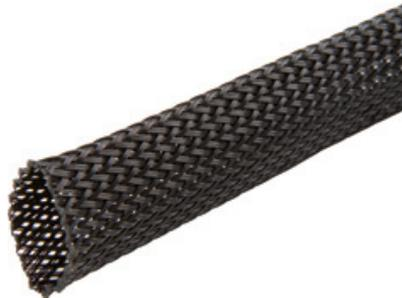
Der Geflechtschlauch lässt sich schnell und einfach auf das zu schützende Objekt aufschieben und passt sich unregelmässigen Formen und Konturen perfekt an. Er kann mit einem mit Kleber beschichteten Schrumpfschlauchabschnitt fixiert werden.
